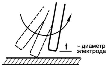
Наиболее простым способом является «Чиркание». Этот способ чаще применяют для разжигания нового электрода. Выполняется он движением, напоминающим зажигание спички: чиркаем электродом по металлу подготовки и в конце этого движения, медленно отводим электрод приблизительно на расстояние равное диаметру электрода. После возникновения дуги стараемся придерживаться заданной длины туги и начинаем проваривать деталь.
