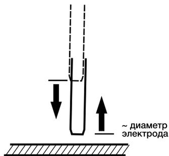
Второй способ «Касание» применяют для разжигания уже работавших электродов, а также в труднодоступных местах. При этом способе электрод подводит вертикально к месту сварки и после легкого прикосновения отводим на расстояние длины дуги. После возникновения дуги стараемся придерживаться заданной длины дуги и начинаем проваривать деталь.
