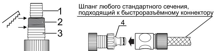
Для подключения шланга с внутренним сечением 25 мм, используйте часть штуцера (1). В этом случае штуцер отрезать не нужно. Для фиксации соединения используйте подходящий хомут.
