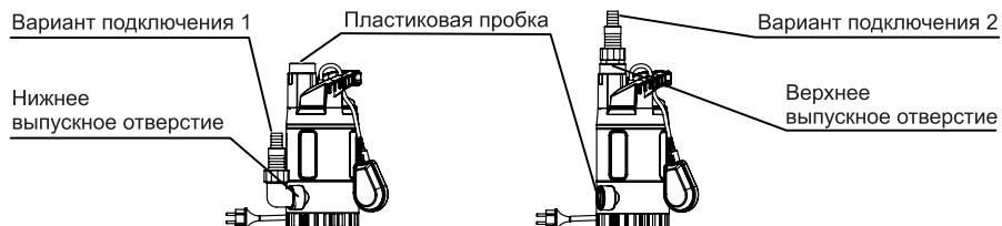
Пользователь может выбрать верхний или нижний выход для воды, воспользовавшись пластиковой пробкой для закрытия ненужного выхода и прилагаемыми патрубками для подключения наиболее удобного выпускного отверстия.
