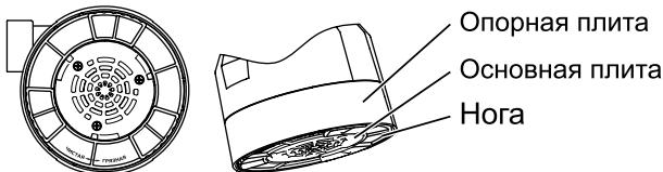
Для установки ноги насоса в положение для перекачки загрязнённой воды, возьмите насос нижней стороной к себе, поверните ногу против часовой стрелки, выдвинете на себя и ещё раз поверните для фиксации. При выдвинутой полностью ноге насос способен перекачивать частицы размером до 30 мм.
