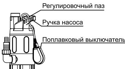
Чем меньше длина между поплавковым выключателем и регулировочным пазом, тем меньше разница между верхним и нижним уровнями воды.
