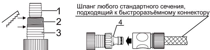
Для подключения шланга с внутренним сечением 25 мм, используйте часть штуцера (1). В этом случае штуцер отрезать не нужно. Для фиксации соединения используйте подходящий хомут.
